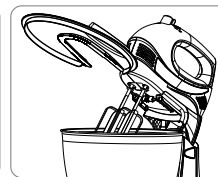
Encaixe a tampa anti-respingo pouco antes dos batedores.
