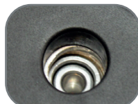
Trava da tampa desativada (sem pressão)
