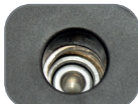
Trava da tampa desativada (sem pressão)
