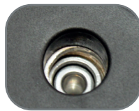
Trava da tampa desativada (sem pressão)
